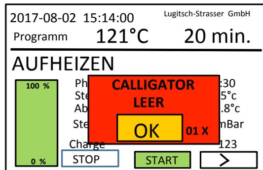
Wenn die Sonde leer anzeigt, können noch 10 Chargen gestartet werden, bis kein Programmstart mehr möglich ist.
